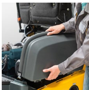
Piezas laterales desmontables fácilmente y sin herramientas.
